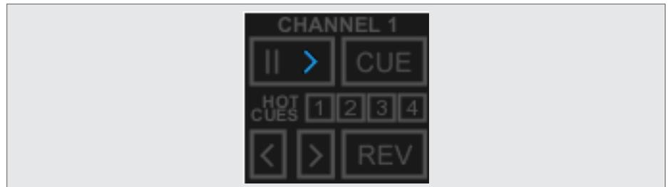
El control de reproducción permite, por una parte, pausar, comenzar, adelantar y retroceder una pista; y por otra, manipular el comportamiento del track.
