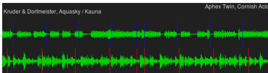
Permite visualizar las frecuencias de las pistas cargadas en los canales derecho e izquierdo e información sobre la posición de reproducción actual, la duración de la pista y el tiempo en BPM.
