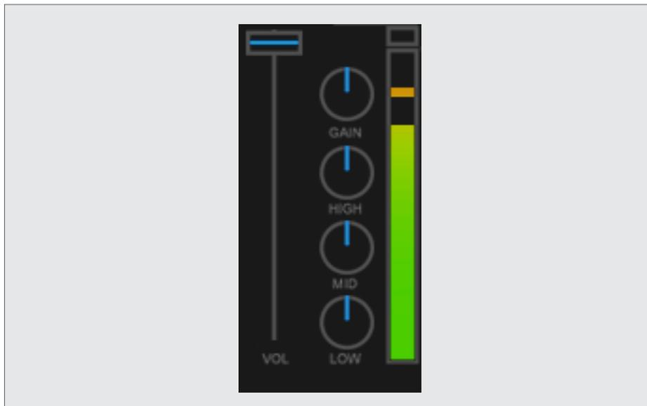
El control deslizante permite aumentar o disminuir el volumen del canal seleccionado. La ganancia (GAIN) se puede utilizar para aumentar la amplificación de una canción para que coincida con el volumen de la canción de otro canal. Los mandos HIGH, MID y LOW se utilizan para modificar las frecuencias altas, medias y bajas.
